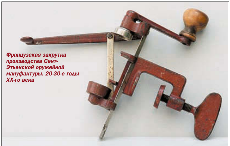
Дореволюционные рекаперы – приспособления для капсулирования гильз и извлечения капсюля типа «центробой»
