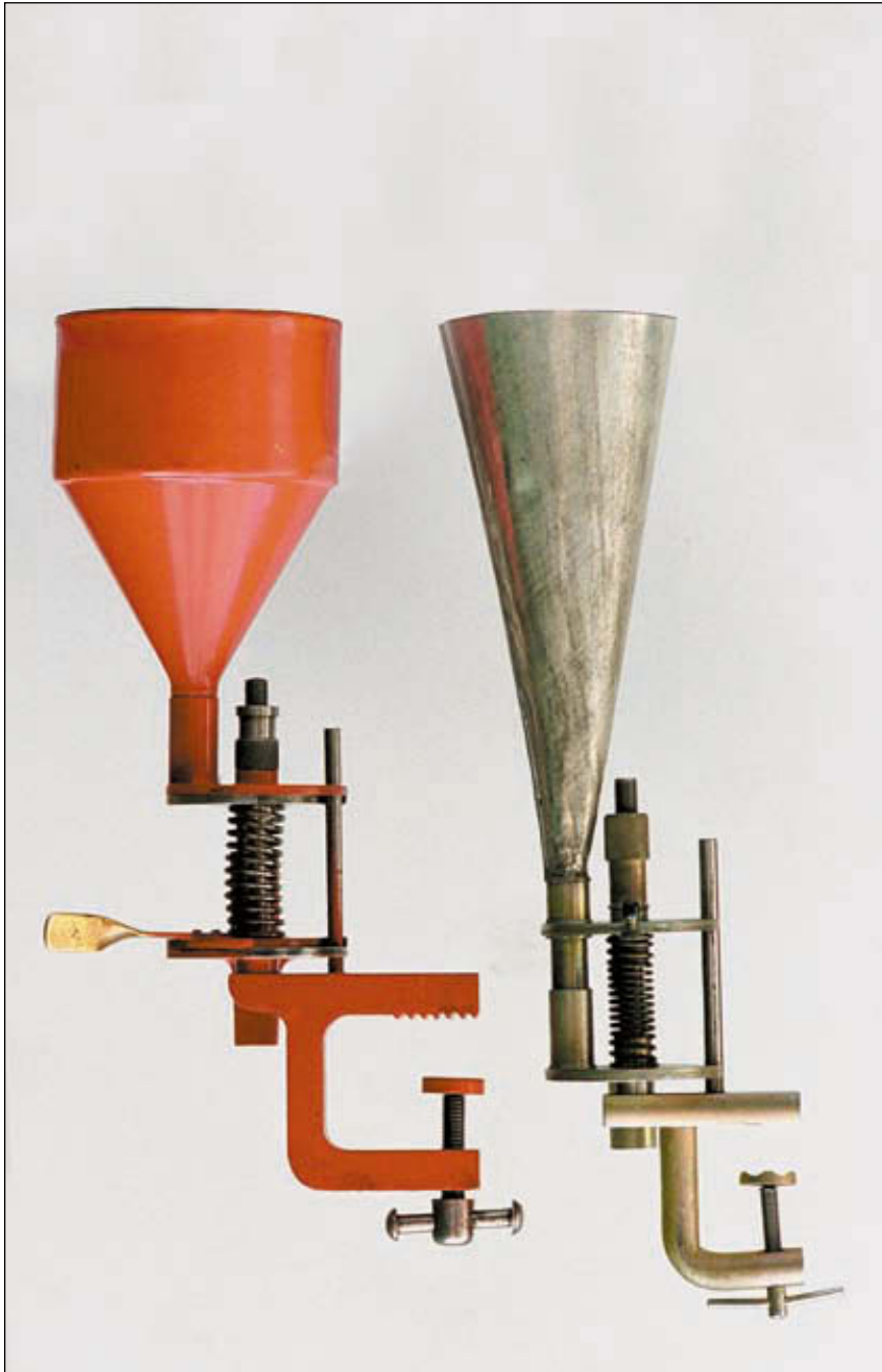
Кустарно, но очень качественно изготовленные дозаторы для пороха (слева) и дроби. СССР, 60-е годы
