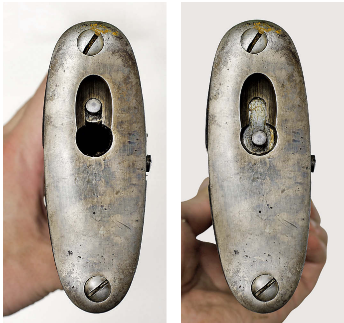
Окно снаряжения магазина в открытом и закрытом положениях
