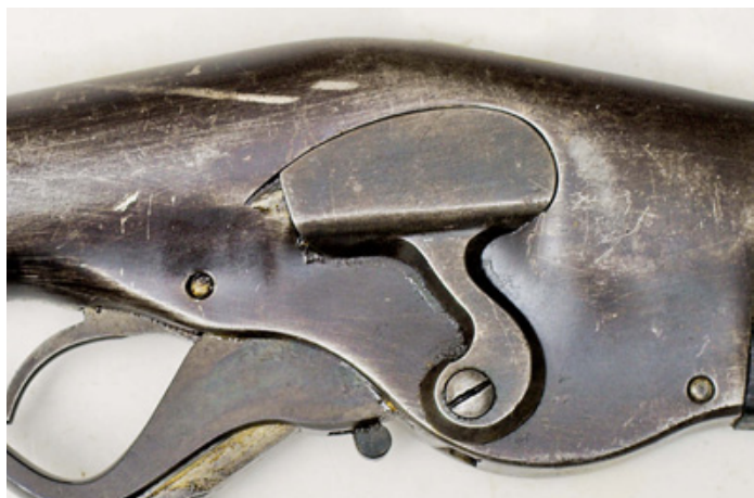
Рычаг перезарядания в закрытом положении, крышка окна выбрасывания стреляных гильз также закрыта, предотвращая попадание грязи и пыли внутрь ствольной коробки
