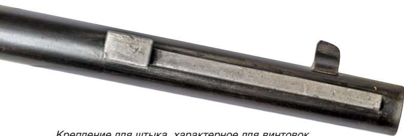
Крепление для штыка, характерное для винтовок системы Эванса только в модификации «карабин»
