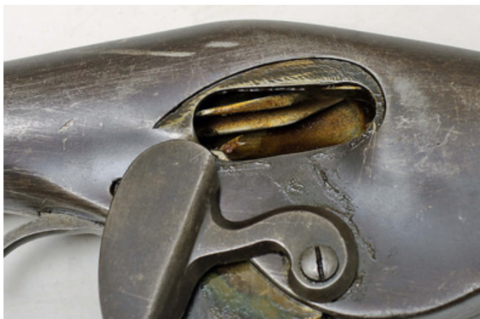
Крышка окна выбрасывания гильзы в открытом положении
