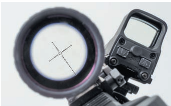
Такая спарка – обычное дело в открытом классе и позволяет обрабатывать различные по размерам и удалённости мишени, переходя с прицела на прицел простым поворотом оружия вокруг оси ствола. Правда, просто это только на словах... Хорошо видна фирменная прицельная марка у прицела Burris
