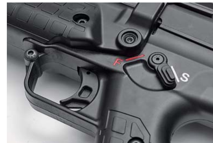
Предохранитель у RFB двусторонний, и пользоваться им удобно
