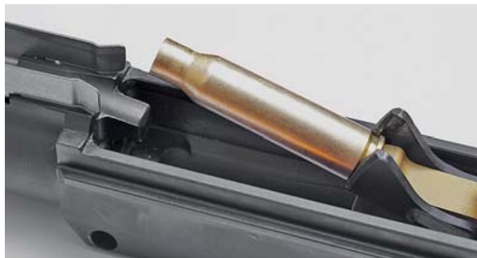
На этом снимке смоделировано промежуточное положение частей оружия перед выбросом гильзы. Обратите внимание на пружинные губки гильзоотвода – они обеспечивают невозможность «возврата» гильзы в ствольную коробку
