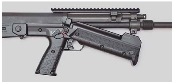
Не очень удачный снимок. Для правильной разборки предпочтительнее «распустить» не переднюю, а заднюю часть ложи – удерживая оружие за цевьё, будет удобнее отделять крышку ствольной коробки и извлекать затворную раму
