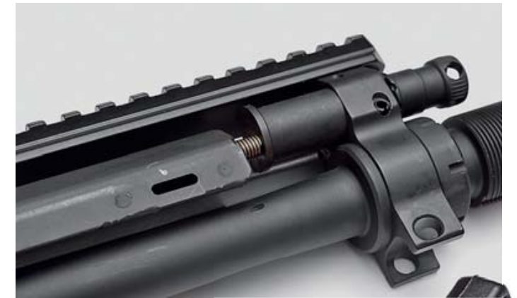
При приходе затворной рамы в переднее положение, выступающая из неё пружина выполняет роль буфера, препятствующего резкому удару о газовый поршень. На верхнем снимке рукоятка взведения затвора снята и видно сквозное отверстие в раме для неё. Рукоятка может быть установлена слева или справа затворной рамы
