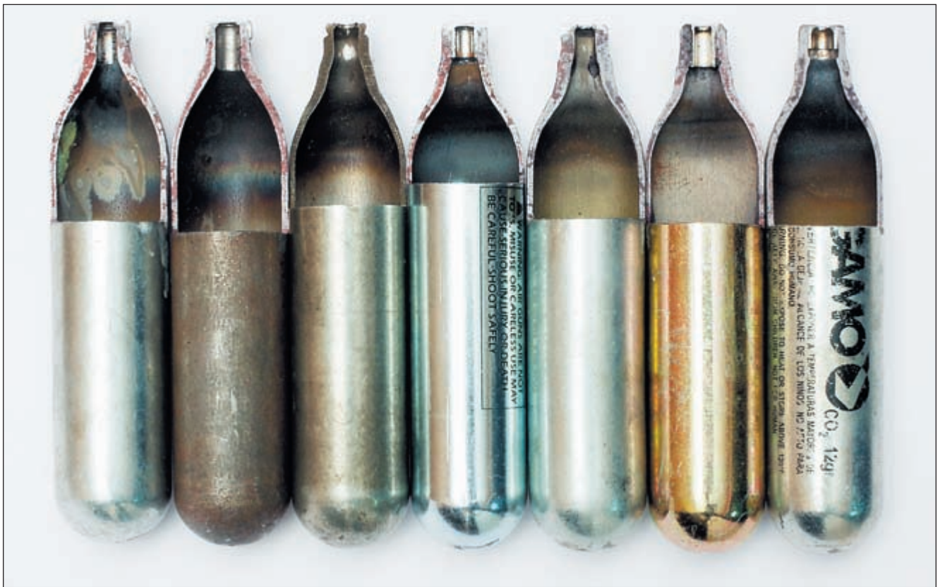
12-граммовые баллончики, продающиеся в российских магазинах (слева-направо): производства ТПЗ старого образца, ТПЗ нового образца, тулский баллончик без пломбы (хорошо видно посадочное место для пломбировки), Eagle, Copperhead, Umarex, Gamo
