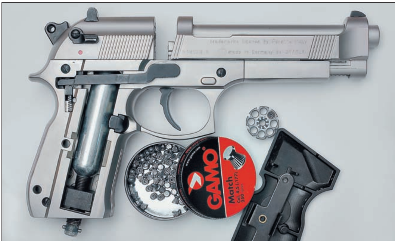
Пневматическая Veretta с самодельным поджимным болтом, имеющим большую надёжность по сравнению с стандартным для Umarex'a рычажным механизмом
