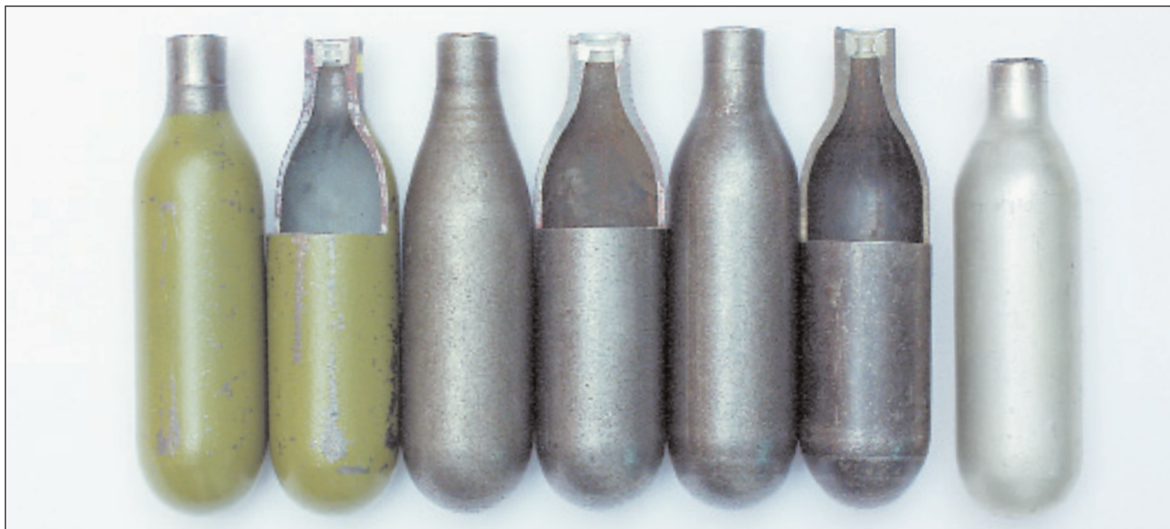
Отечественные 7-граммовые баллончики. Зелёные – производства «Позис» (Зеленодольск), серые – петербургского производства. Крайний справа – экзотический сифонный баллончик, который не подходит ни к одному виду газобаллонного оружия. На снимке заметны отличия в конструкции пломб. Коническое углубление «позисовской» пломбы часто препятствует нормальному накаливанию, особенно у оружия с утолщённой или несоосной иглой, что довольно часто встречается на российском оружии
