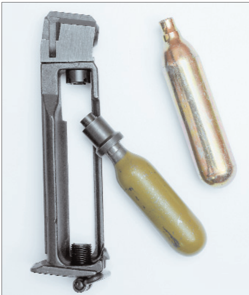
7-граммовый баллончик при помощи переходника может использоваться в оружии, рассчитанном на применение 12-граммового баллончика
