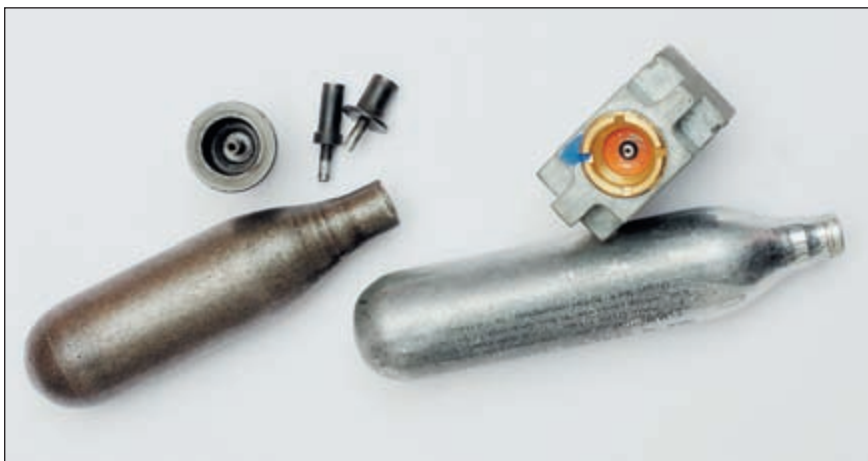
В посадочном месте клапанного устройства под 12-гр баллон предусмотрено одновременное накачивание баллона и герметизация соединения. В случае с 7-граммовым баллоном это не позволяют сделать высота иглы и конструкция пломбы, в результате чего происходит ощутимая потеря газа в момент накачивания
