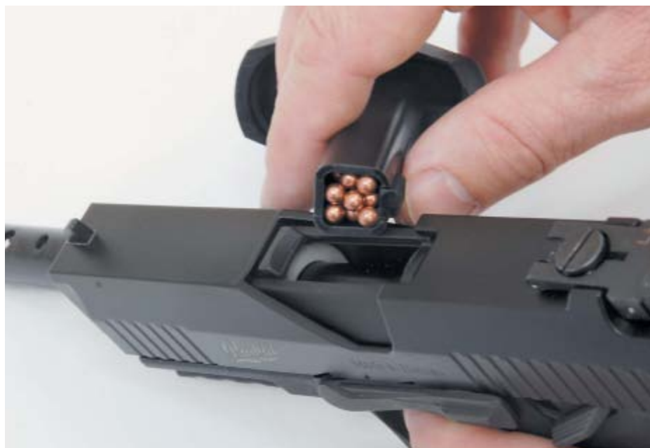
Вместимость бункерного магазина пистолета – 100 шариков калибра 4,5 мм
