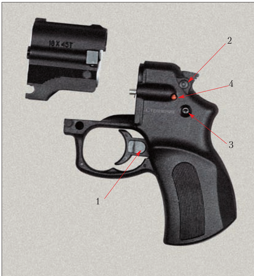
MP-461 «Стражник» с отсоединённой снаряжённой кассетой.
