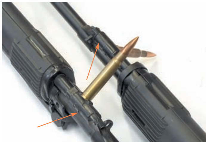
Расположение стравливающих отверстий газового регулятора (установка газ 1) у СВДК (слева) и СВДС различно (указаны стрелками). Соответственно и расположение зацепов под фланец гильзы для изменения установки газового регулятора неодинаково. У СВДК кольцо передней антабки крепления оружейного ремня значительно крупнее
