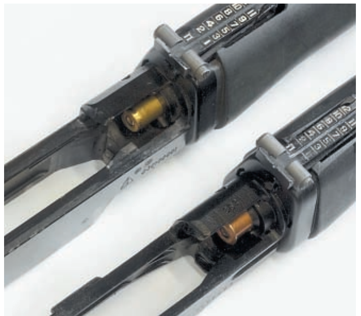
Вид сверху на ствольные коробки СВДК и СВДС. Ясно виден способ фиксации гильзы в патроннике
