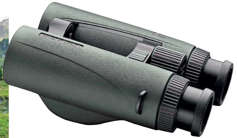
Общий вид нового бинокля Swarovski Optik со встроенным дальномером. Одной из важнейших его функций является определение скорректированной дистанции стрельбы в зависимости от угла места цели
