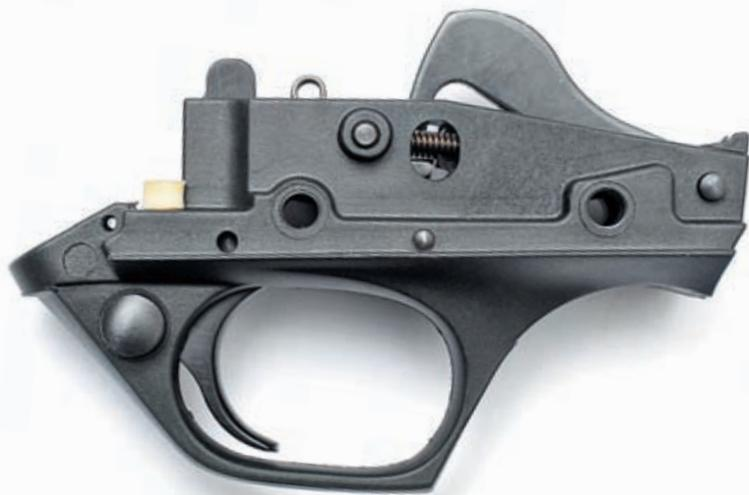
*Ударно-спусковой механизм карабина имеет вполне традиционную конструкцию. На фото курок взведён*
