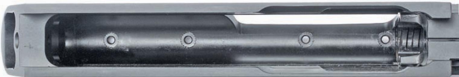
*Винты, крепящие планку Picatinny к ствольной коробке, вворачиваются в стальные закладные элементы. На фото хорошо виден верхний сегмент боевых упоров на стволе карабина*
