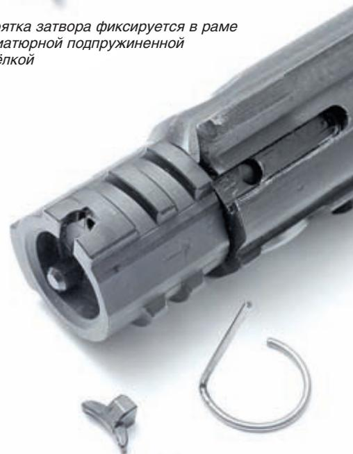
Рядом с затвором лежат отделённый выбрасыватель (экстрактор) и его пружина, кольцевая часть которой в рабочем положении охватывает тело затвора сразу за боевыми упорами
