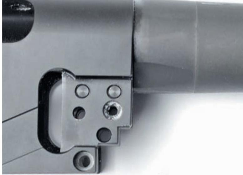
*Направляющий стержень возвратной пружины и толкателя упирается не в ствольную коробку, а в поперечный калёный штифт (показан стрелкой). При этом винт, проходящий через эллиптическое отверстие в стержне лишь предохраняет стержень от выпадения вперёд при ударах подвижных частей. Обратите внимание, что он дополнительно зафиксирован спецклеем и если вы его всё-таки выкрутили, не забудьте посадить опять на клей – в качественных изделиях мелочей не бывает*
