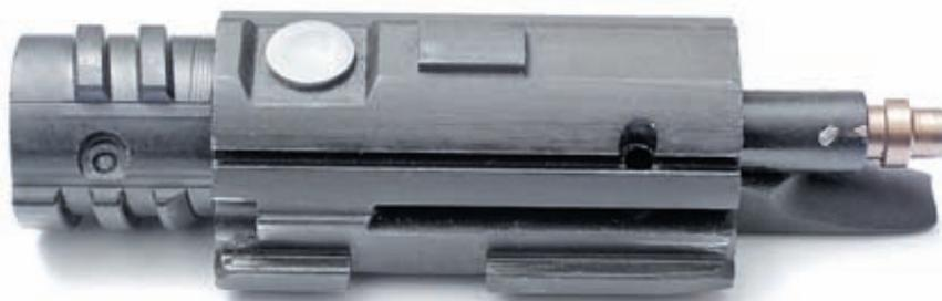
Частично разобранная затворная группа карабина. На переднем плане рычаг, который, взаимодействуя с выступом ствольной коробки, обеспечивает невозможность раннего поворота затвора относительно рамы при движении деталей. Длинное «перо» затворной рамы не позволяет достать курку до ударника, если рама не достигла крайнего переднего положения
