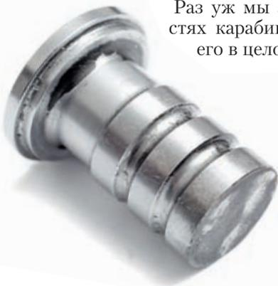
*На газовом поршне хорошо различим нагар от заводской стрельбы и двадцати выстрелов в редакции. «Мягкой» чисткой он не удаляется, но на функционирование газового двигателя такое загрязнение не влияет*
