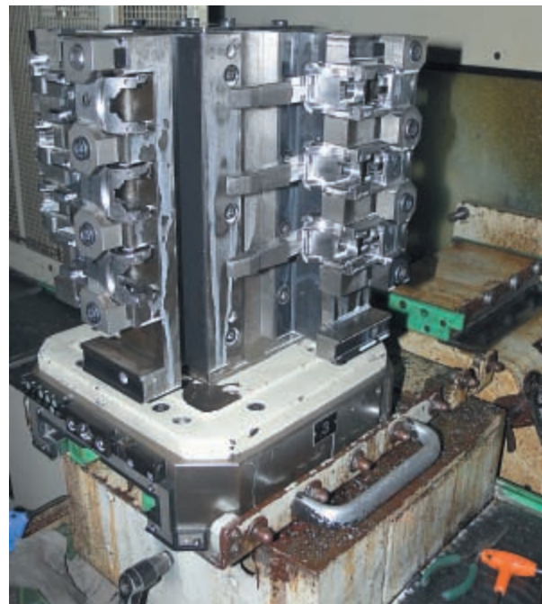
Детали будущих вертикалок в процессе обработки
