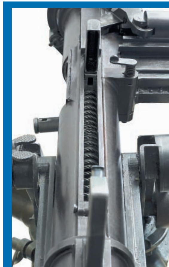
Вид сверху. Хорошо видна мощная возвратно-боевая пружина
