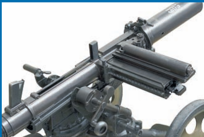
Обратите внимание на магазин и механизм вертикальной наводки
