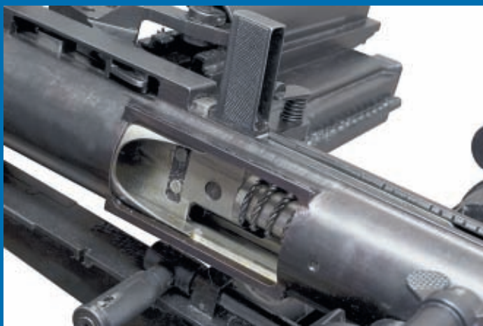
Вид слева. Окно ствольной коробки для того чтобы вручную вложить туда первый выстрел при зарядании оружия
