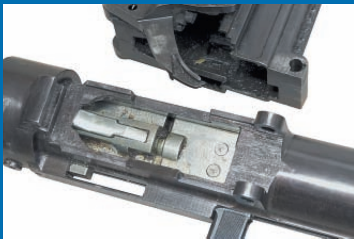
Вид на окно ствольной коробки справа для подачи выстрелов из магазина
