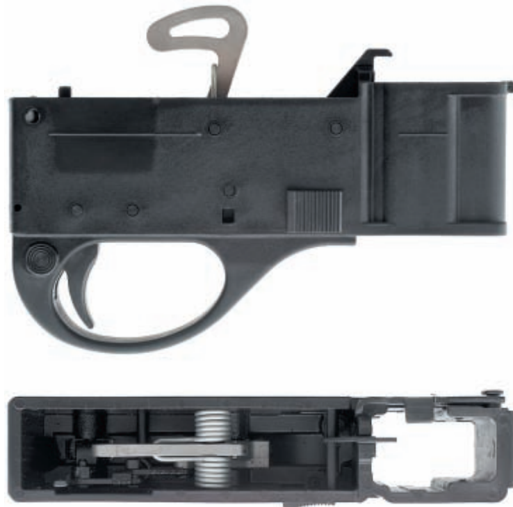
Ударно-спусковой механизм «Ремингтона» лаконичен как снаружи, так и внутри — пластиковый корпус, пружины и несколько металлических деталей простой формы. На фото хорошо видны кнопка предохранителя в основании спусковой скобы, отражатель и курок несколько необычной формы
