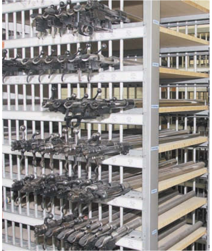
Стеллажи с баллистическими стволами, которые используются для испытательных стрельб
