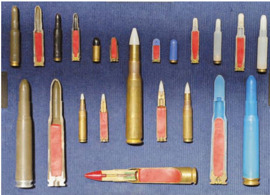
RWS производит и боевые патроны, в том числе холостые и специальные. Внизу горизонтально в разрезе показан «короткобойный» патрон, используемый на стрельбах в условиях небольших полигонов. Головная пластиковая часть пули, предназначенная исключительно для обеспечения правильного досылания патрона в патронник, вышибается порохowymi газами, когда пуля ещё находится в канале ствола. Вследствие этого сама пуля, имеющая далёкую от идеальной баллистическую форму, быстро теряет скорость. Оказывается в условиях густонаселённой Европы это актуально
