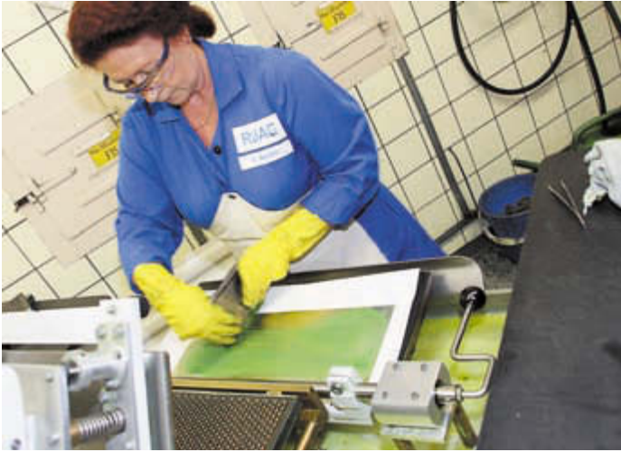
Капсюльные колпачки заполняются иницирующим составом вручную с помощью резинового шпателя. Сам состав до высокотемпературной сушки безопасен
