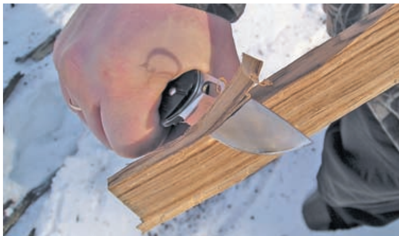
При строгании сухой древесины дуба (для разжигания костра, в зимних условиях) нержавеющая сталь 13C26 прекрасно держит заточку
