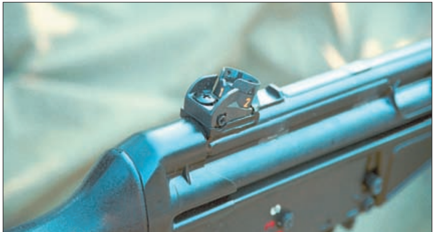
Установке целика «1» для стрельбы на дистанцию 100 м соответствует открытая прорезь треугольного сечения, а от 200 до 400 м (установки «2», «3» и «4») прицеливание осуществляется через диоптрические отверстия в поворотном барабанчике
