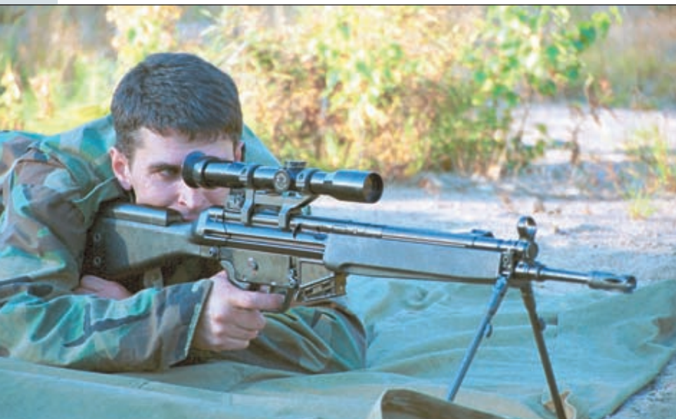
Для удобства прицеливания из винтовки с оптическим прицелом на приклад установлен дополнительный упор для щеки стрелка
