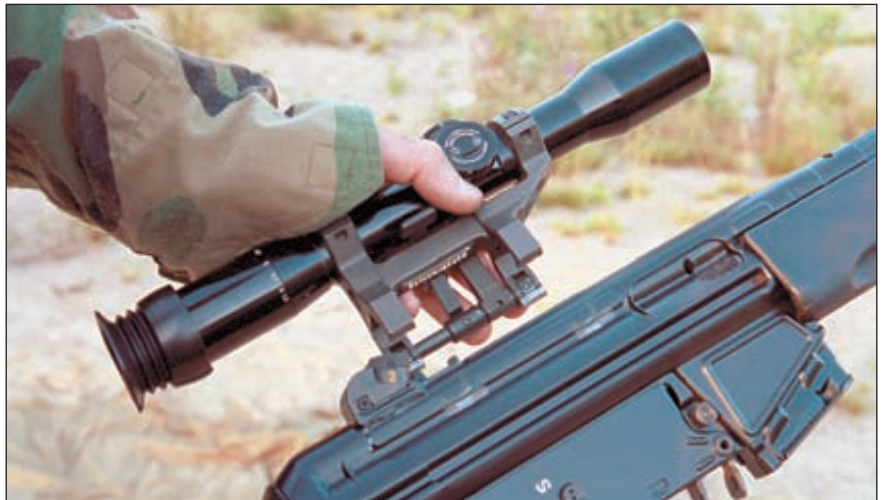
Кронштейн, на котором, прицел устанавливается на винтовку, изготовлен из стали и предусматривает возможность многократного быстрого снятия оптики с последующей установкой без повторной выверки
