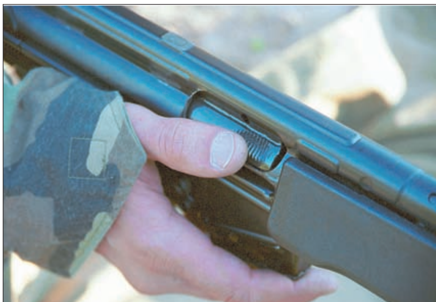
Проблема ручного докрывания затвора (при необходимости) в немецкой винтовке решена наиболее простым и дешёвым способом – на поверхность затвора нанесены поперечные бороздки, упираясь в которые пальцем предполагается доводить затвор в крайнее переднее положение
