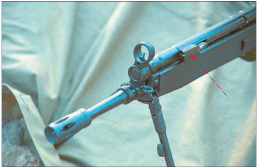
Приведение оружия к нормальному бою по вертикали осуществляется подбором мушек различной высоты. Откидная рукоятка взведения затвора расположена с левой стороны над стволом (указана стрелкой)
