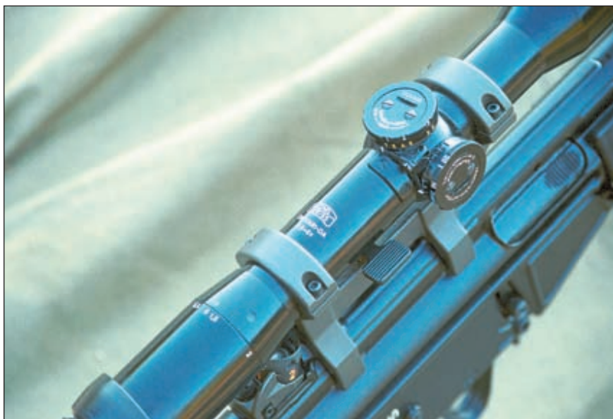
Механизм ввода вертикальных поправок оптического прицела с переменной кратностью Zeiss Diavari-DA 1,5-6x оцифрован до 750 м.
