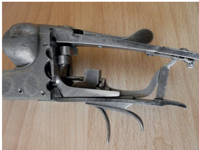
Механизм патентованного эжектора Фердинанда Куралли (слева) и часть замка (справа). Хорошо виден механизм автоматического предохранителя и интерсептора (к нему больше всего подходит определение «перехватывающее шептало»)
