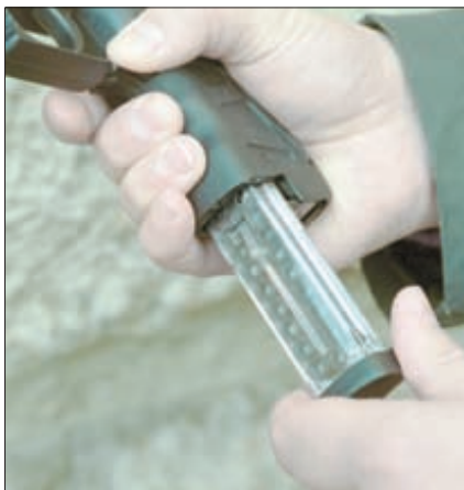
Баллончик устанавливается в гнездо тыльной части рукоятки, в передней части располагается 28-зарядный магазин. а – кнопка фиксации крышки гнезда баллончика б – винт для предварительного поджатия баллончика
