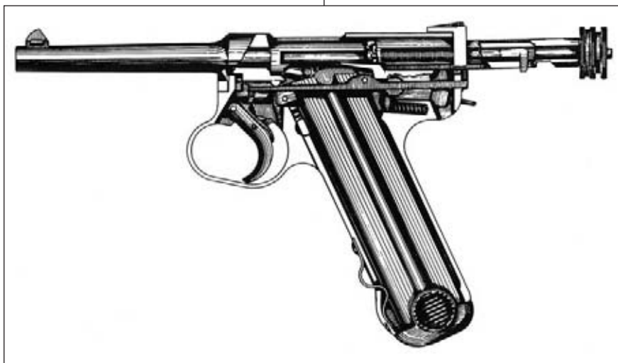
Схема взаимного расположения деталей пистолета «Намбу Тайсё 14» в момент времени, когда затвор находится в крайнем переднем положении (вверху) и в крайнем заднем положении
