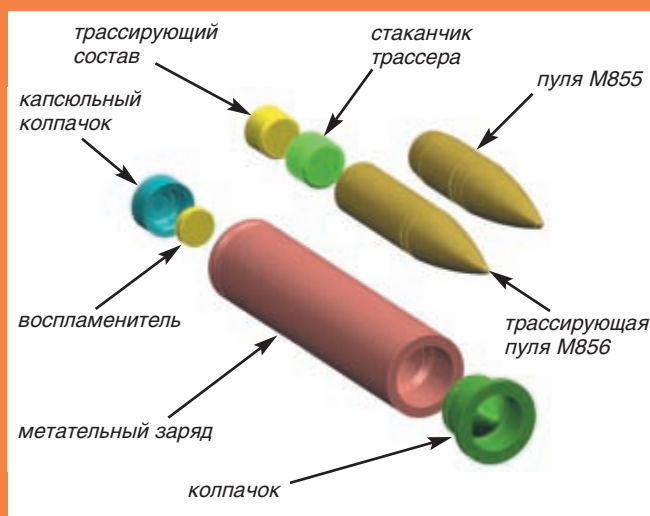
Схема устройства безгильзового боеприпаса, в котором могут применяться обычная M855 или трассирующая M856 пули
