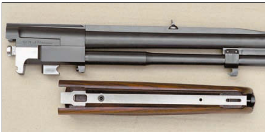
Запирающая деталь замка. При её извлечении производство выстрела из ружья становится невозможным
