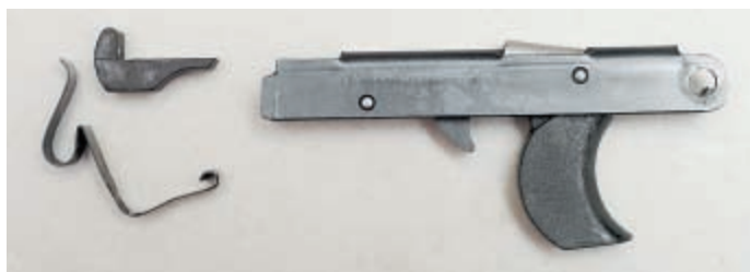
Двухрежимный УСМ очень прост по устройству и многие его детали изготовлены из пластмассы. Рядом с пластинчатой пружиной сложной формы лежит деталь, подтормаживающая затвор в конце его движения назад
