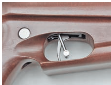
Предохранитель включен. В этом положении нажать на спусковой крючок очень сложно
