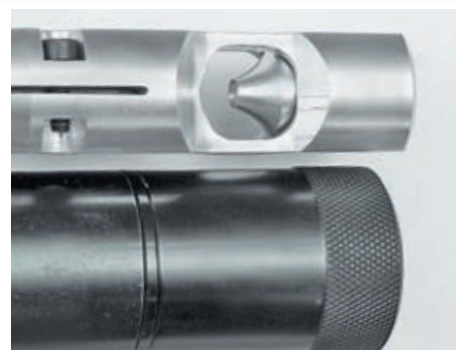
Компенсатор на стволе винтовки MPR. Обгоняющий пулю воздух отсекается вставкой с криволинейной конической поверхностью
