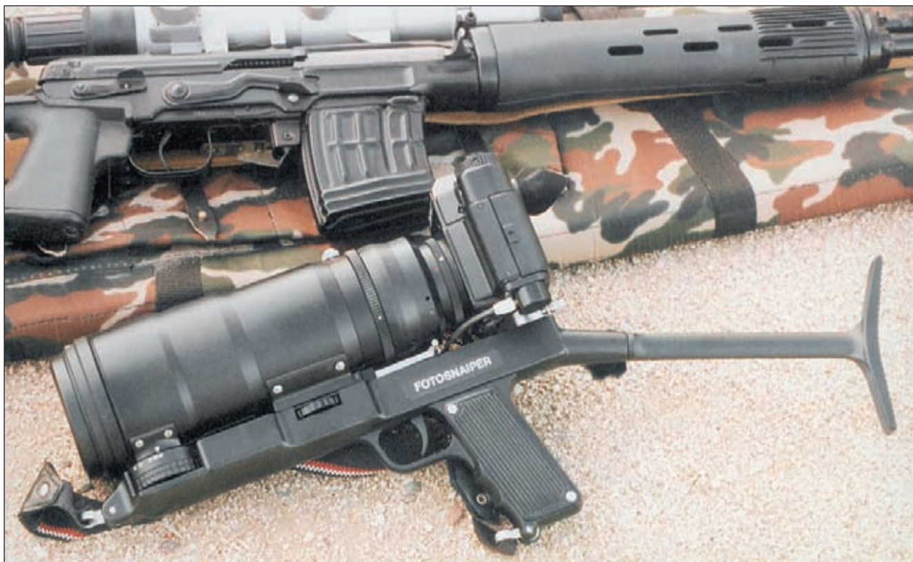
Камеры серии «Фотоснайпер» представляли собой фотоаппарат с телеобъективом на своеобразной «ружейной» ложе. В последней версии в качестве фотоаппарата используется камера «Зенит-122С» с длиннофокусным объективом «Таир-3С»
