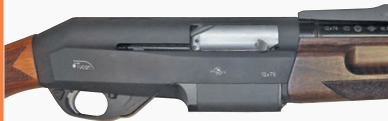
Ружья 20-го (вверху) и 12-го калибров визуально легко отличить друг от друга. Магазин «двадцатки» не выступает за габариты ствольной коробки
