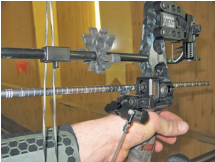
Для измерения длины растяжки можно использовать специальную мерную стрелу
