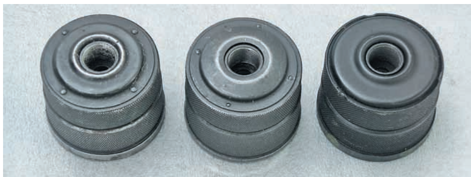
Варианты крепления тарельчатой пружины к крышке головки ПБС-1
