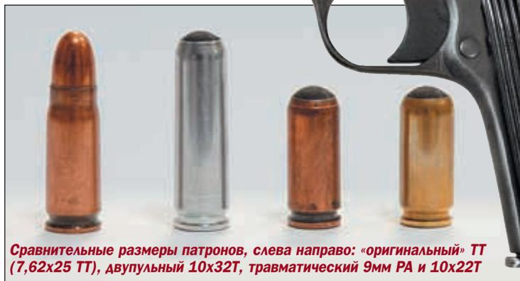
Сравнительные размеры патронов, слева направо: «оригинальный» ТТ (7,62х25 ТТ), двухпульный 10х32Т, травматический 9мм РА и 10х22Т
