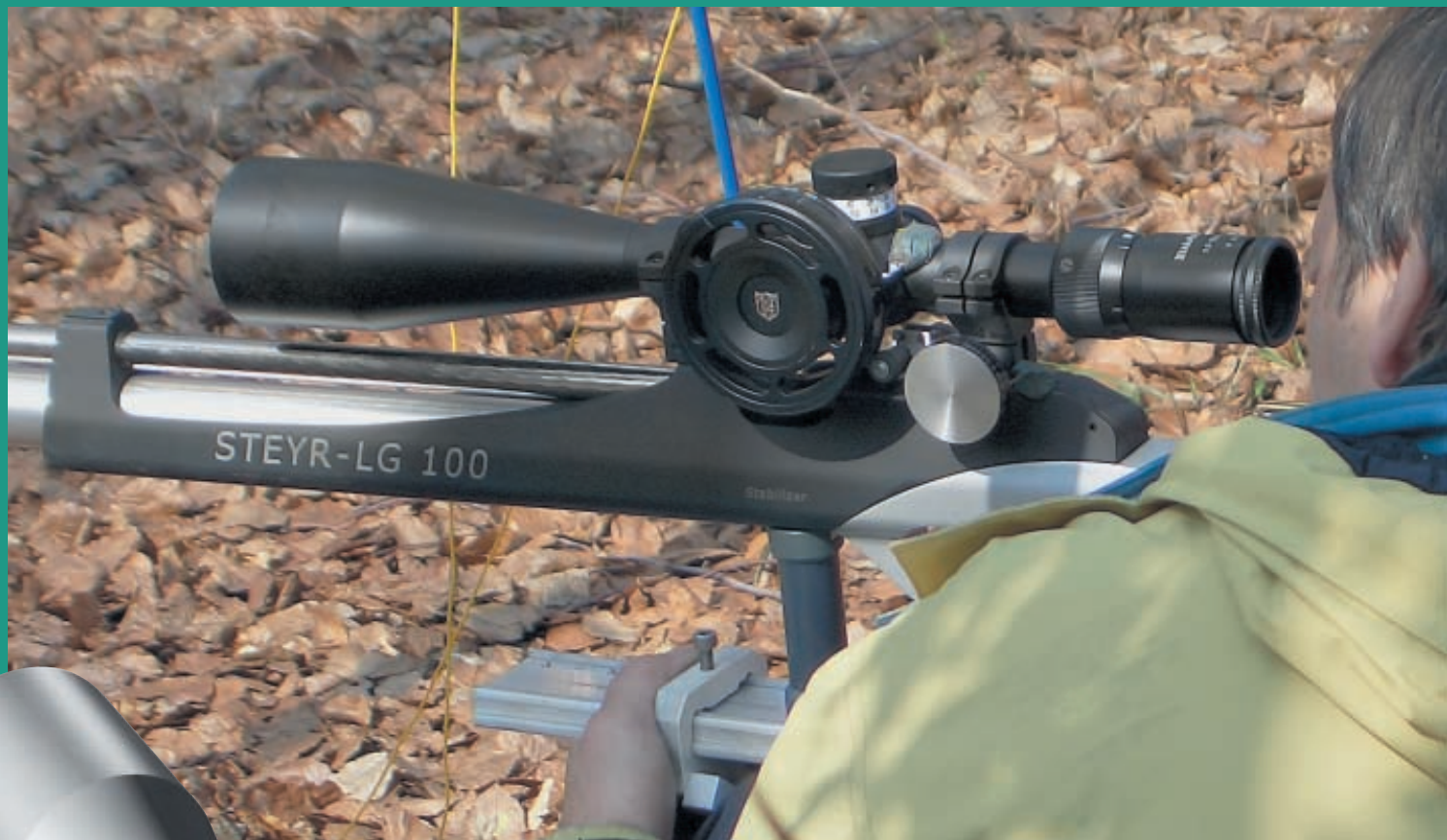
Популярный прицел Nikko Stirling Diamond 10-50x60. Виден оригинальный механизм регулировки параллакса с помощью ременной передачи
