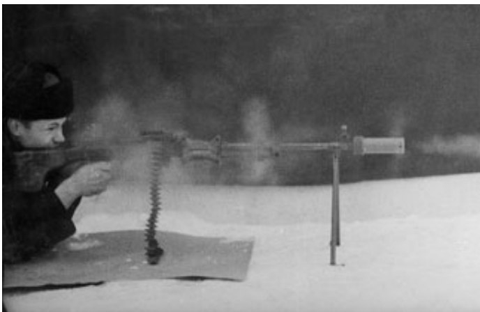
Стрельба из пулемёта РПД опытными патронами с прибором для бесшумной и беспламенной стрельбы
