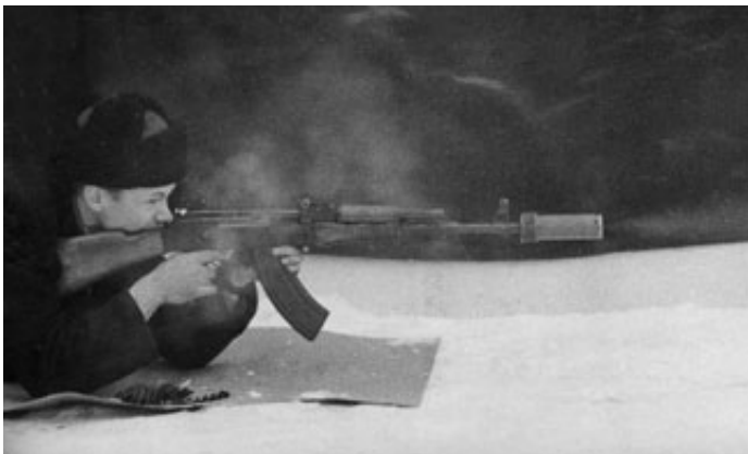
Стрельба из автомата АК опытными патронами с прибором для бесшумной и беспламенной стрельбы
