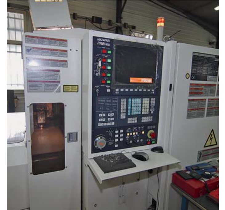
Сегодня на фабрике автоматизирована не только обточка и полировка серийных моделей. На снимке вы видите лазерный раскройный стенд, позволяющий минимизировать отходы и обеспечить превосходную точность и воспроизводимость форм заготовок из стального листа
