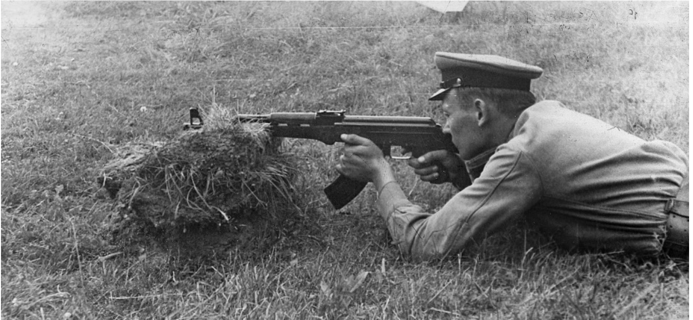
Испытания по определению кучности стрельбы из положения лёжа с упора
