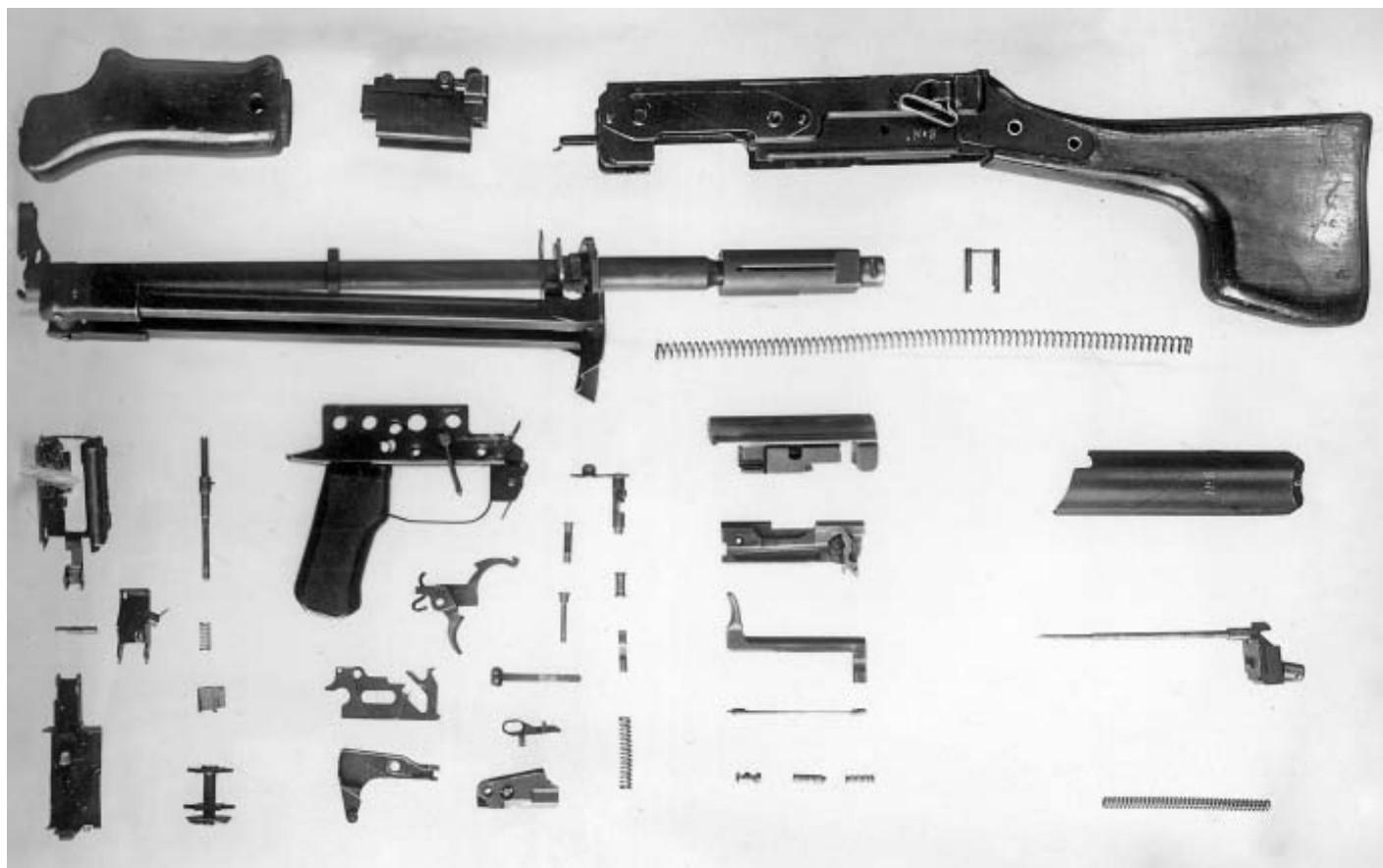
Полная разборка пулемёта Коробова ТКБ-516
