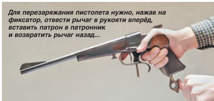
Стрелок может взвести шнеллер при помощи рычага на левой стороне пистолета
