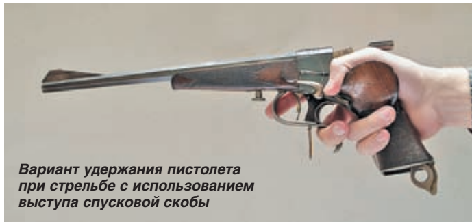
Для перезаряжания пистолета нужно, нажав на фиксатор, отвести рычаг в рукояти вперёд, вставить патрон в патронник и вернуть рычаг назад...
