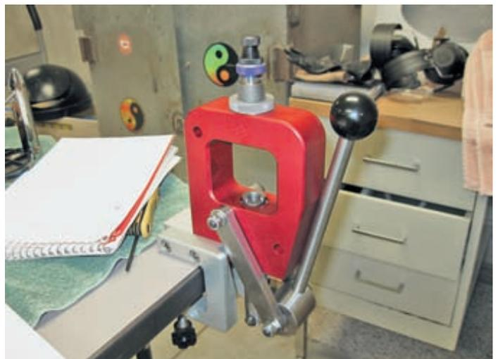
*Пресс Vango. Такие прессы ещё называют резьбовыми из-за установки матрицы на резьбе*
