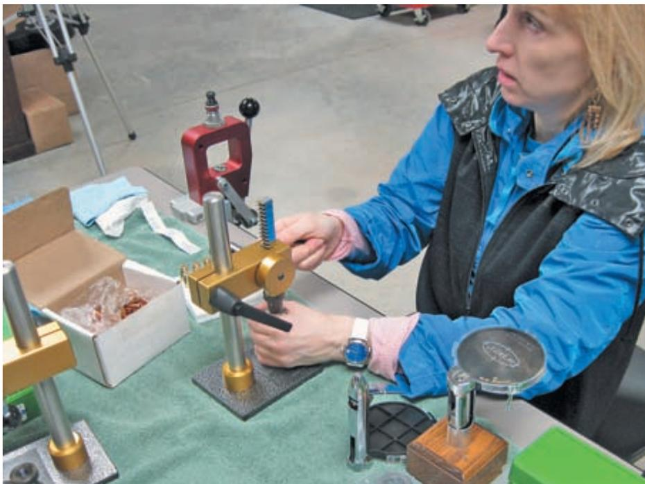
*С помощью нажимного пресса Светлана устанавливает пулю в гильзу. Тщательность на каждом этапе снаряжения патрона – одна из важнейших составляющих точности стрельбы*
