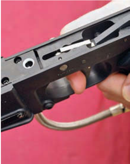
Спусковой механизм маркера GI FM50 Field
