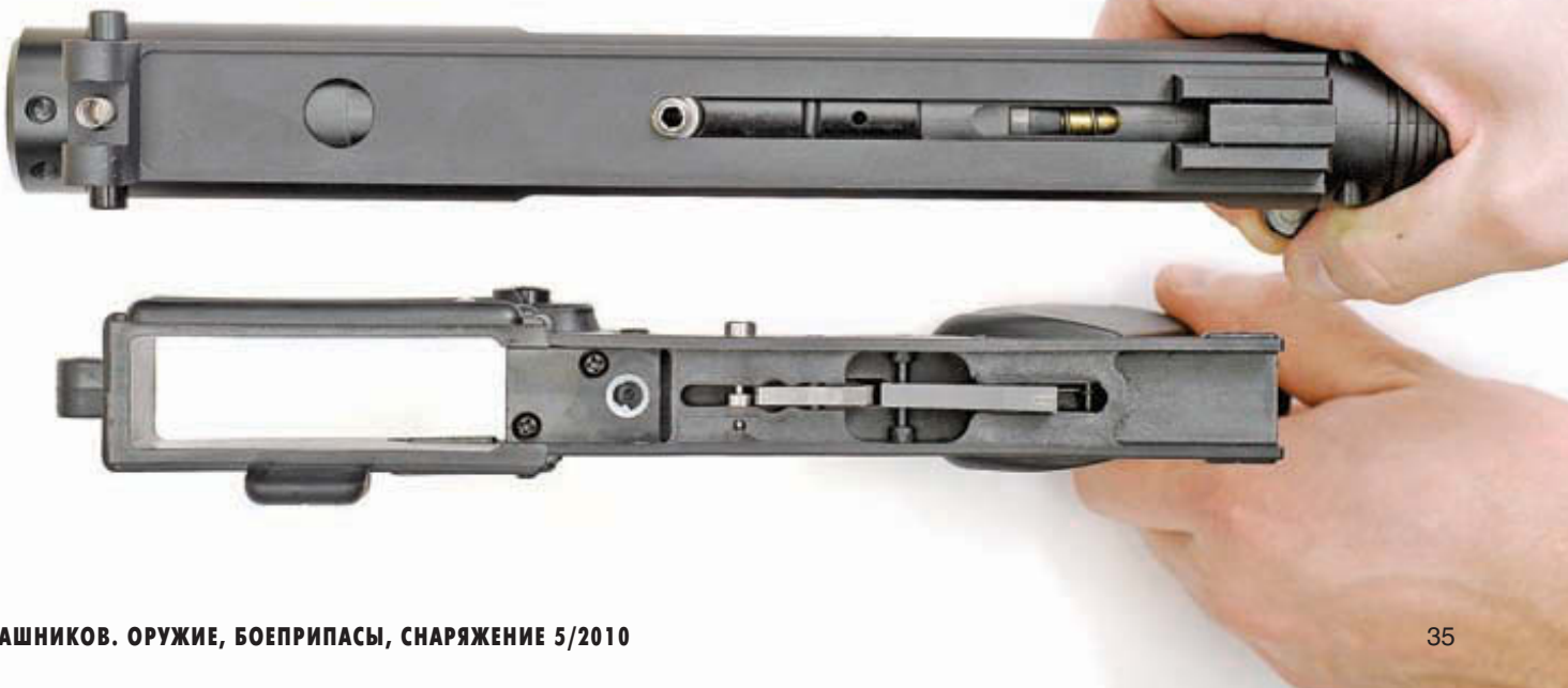
Вид маркера GI FM50 Field, разделенного на две половины
