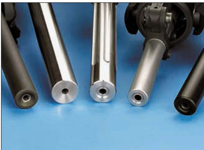
Дульные части (слева направо SL8, Sabre, OA-15, OA-SPR, OA-UG): все образцы имеют тщательно обработанные, заглублённые торцы дульного среза. Толщина стволов при этом колеблется от 17 мм (SPR) до 23 мм
