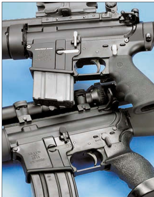
По качеству обработки поверхности ствольная коробка фирмы Oberland Arms намного превосходит невзрачную Sabre. Управляющие элементы из нержавеющей стали, которыми может дооснащаться винтовка, сделают её ещё привлекательнее
