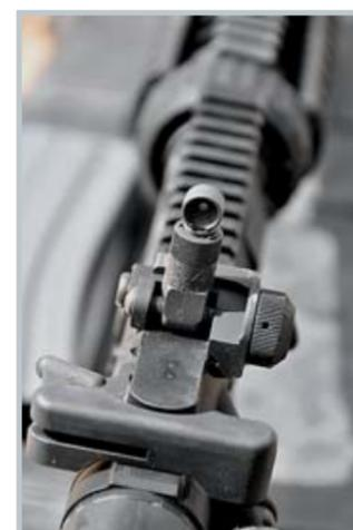
Сзади: к механическому прицелу винтовки Mk12 MOD1 SPR относится складывающийся диоптрический целик, также производимый компанией Knight's Armament.
