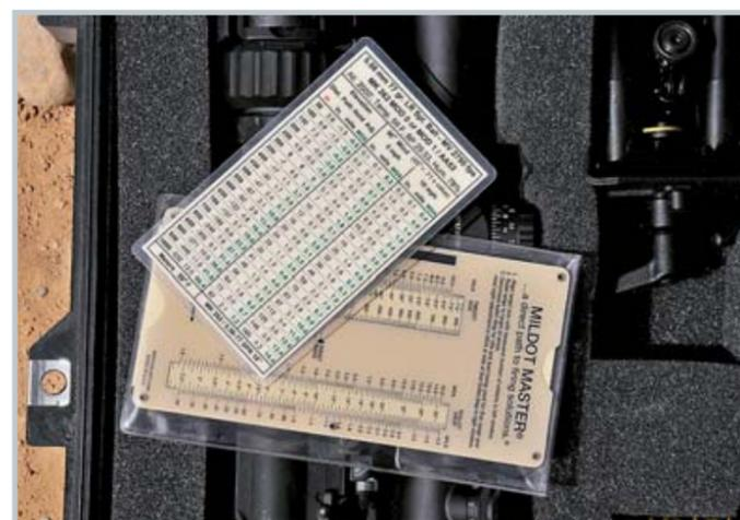
«Таблица умножения» для стрелка: с помощью счётной линейки Mildot-Master можно рассчитывать дальности стрельбы и понижения траектории.
