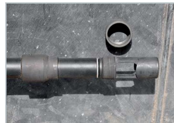
Уменьшающий: при стрельбе без глушителя снижение отдачи и подброса дульной части обеспечивает компенсатор.
