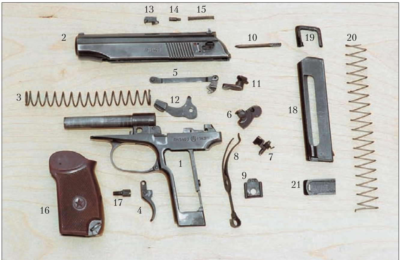
Детали полной разборки 9-мм пистолета Макарова (ПМ).
