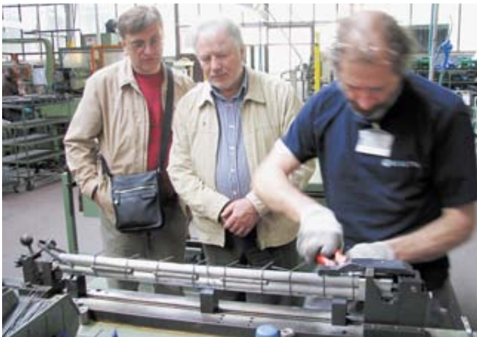
Увязка стволов в блок перед их пайкой – одна из самых сложных и ответственных операций. За работой мастера наблюдают Сергей Лабынцев (слева) и Анатолий Злобин (в центре)
