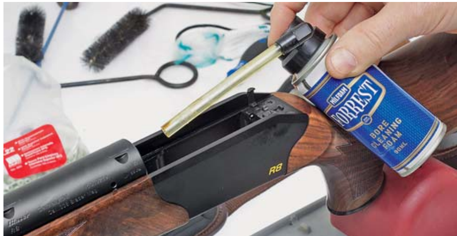
Пенообразный растворитель-очиститель нагара и омеднения Forrest лучше использовать на этапе основательной чистки. Заполненный через трубку пеной ствол выдерживается до получаса, затем следует его удаление патчами досуха. После этого канал ствола следует обильно смазать нейтральным оружейным маслом
