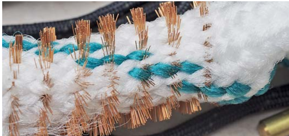
Элементы бронзовой щётки-ерша, вплетённые в ткань гибкого «шомпола». Используется для срочной чистки после стрельбы или охоты. Торчащую металлическую щетину необходимо обернуть ветошью, сильно смазанной оружейным маслом Gun-Guard, например, Oleum SX, Nitrolinol Berger, Anthios и др. Ветошь меняется на новую после каждого прохода канала ствола. Всего требуется 5-6 проходов, после чего ствол легко «терпит» до основательной чистки
