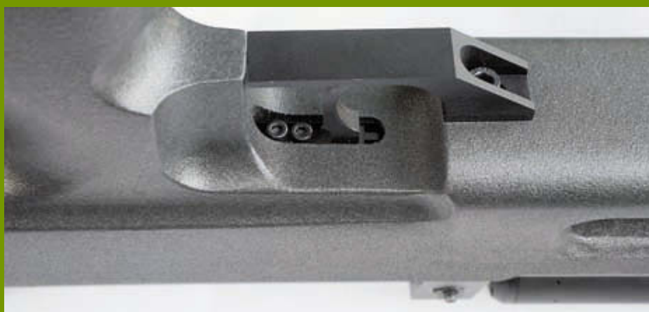
Добраться до регулировочных винтов с головкой под шестигранный ключ в переднем узле УСМ можно сбоку, но отверстие в спусковой скобе не помешало бы. Большой винт справа – единственный крепежный элемент, соединяющий стреляющий механизм с ложей
