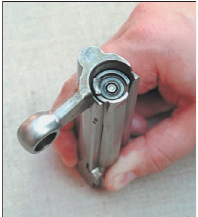
Подвижные детали узла запирания. Обращает на себя внимание увеличенное отверстие для выхода ударника в зеркале затвора. На иллюстрации слева ударник находится в крайнем заднем положении. После выстрела выбитый из гильзы капсюль воздействует на ударник, приводя в движение подвижные части. Справа ударник находится в крайнем переднем положении
