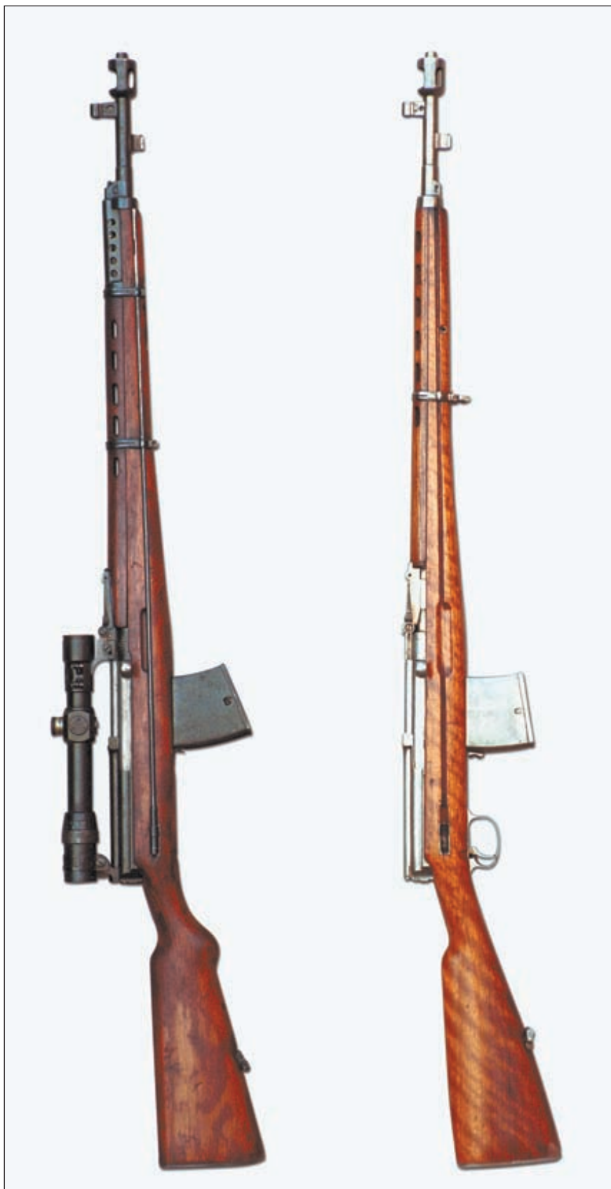
Образцы самозарядных винтовок Токарева, хранящиеся в фондах Артиллерийского музея: СВТ-38, на данной винтовке отсутствуют детали УСМ (слева) и экспериментальная винтовка, автоматика которой работает на принципе отвода части пороховых газов через дно гильзы
