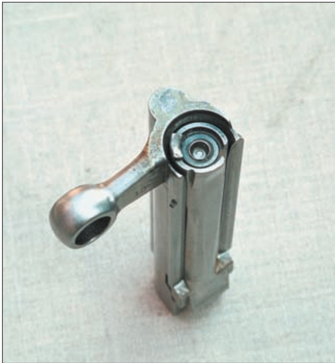
Подвижные детали узла запирания. Обращает на себя внимание увеличенное отверстие для выхода ударника в зеркале затвора. На иллюстрации слева ударник находится в крайнем заднем положении. После выстрела выбитый из гильзы капсюль воздействует на ударник, приводя в движение подвижные части. Справа ударник находится в крайнем переднем положении
