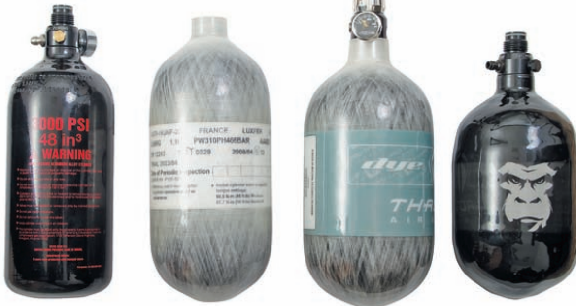
Типовые пейнтбольные баллоны: слева направо: алюминиевый баллон производства Guerilla, объём 0,8 л; композитная колба производства Luxfer (1,1 л); композитный баллон DYE Throttle (1,1 л); композитный баллон Myth (0,8 л)
