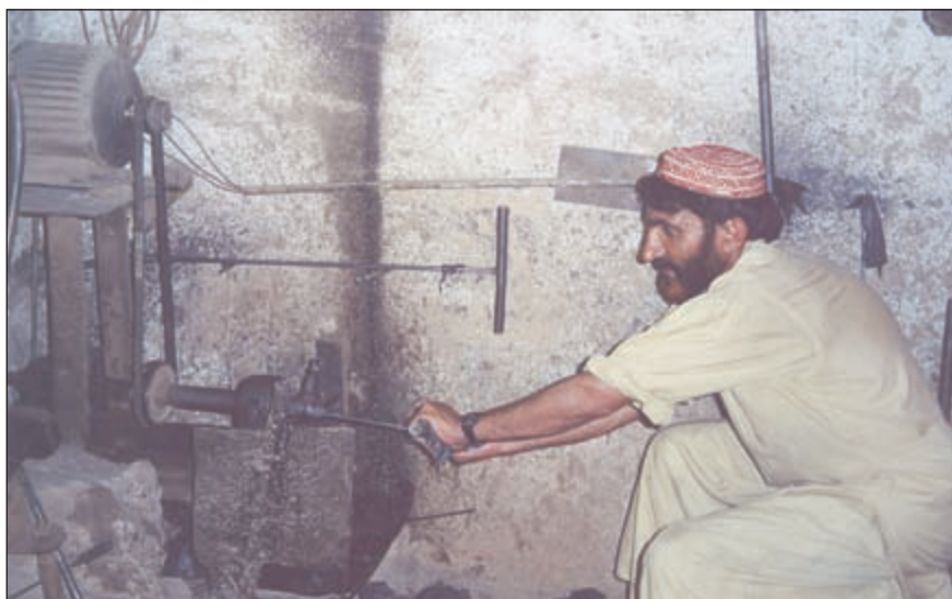
Агрегат для сверления стволов, позволяющий обрабатывать сразу две заготовки
