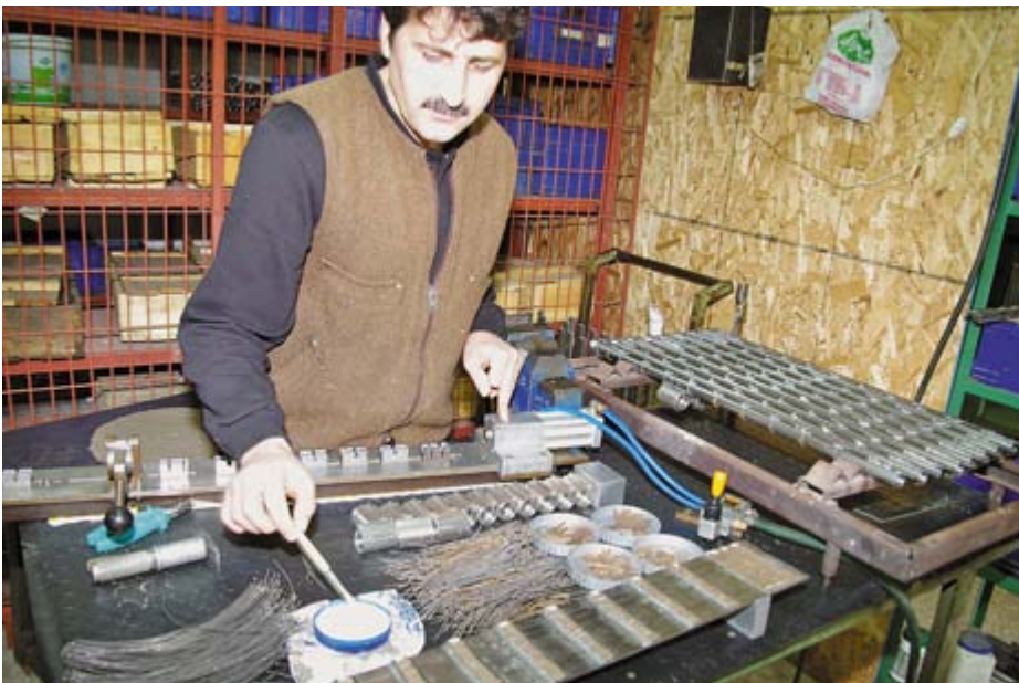
Пайка стволов производится на высокотемпературный серебряный припой
