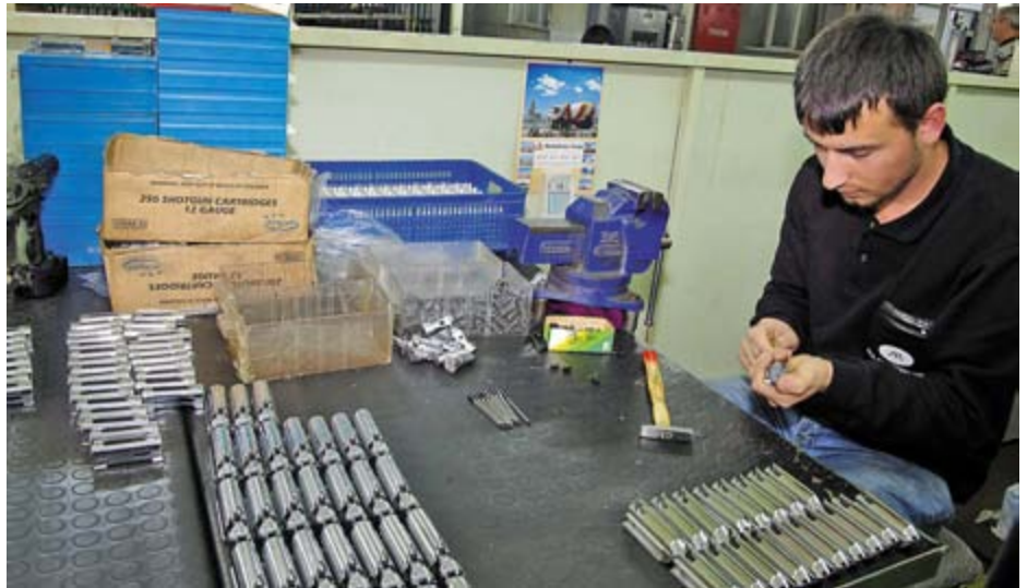
Даже при широком внедрении в производство современных обрабатывающих центров (вверху) от ручной работы по сборке затвора не может уйти ни один производитель оружия (внизу)
