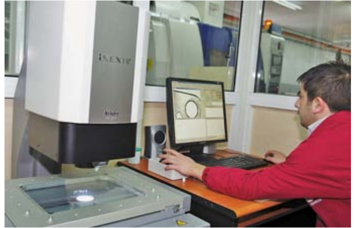
В метрологической лаборатории контроль размеров осуществляется не только измерительными инструментами, но и с помощью современной опто-электронной установки. В ближайших планах покупка автоматизированного контактного станда
