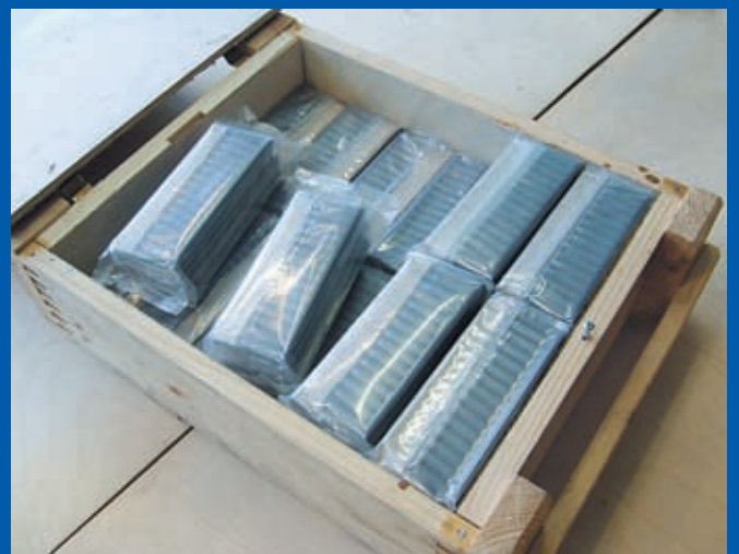
Новая упаковка позволяет обходиться без укупорки патронов в металлические коробки, что избавляет от очень трудоёмкой операции по их вскрытию
