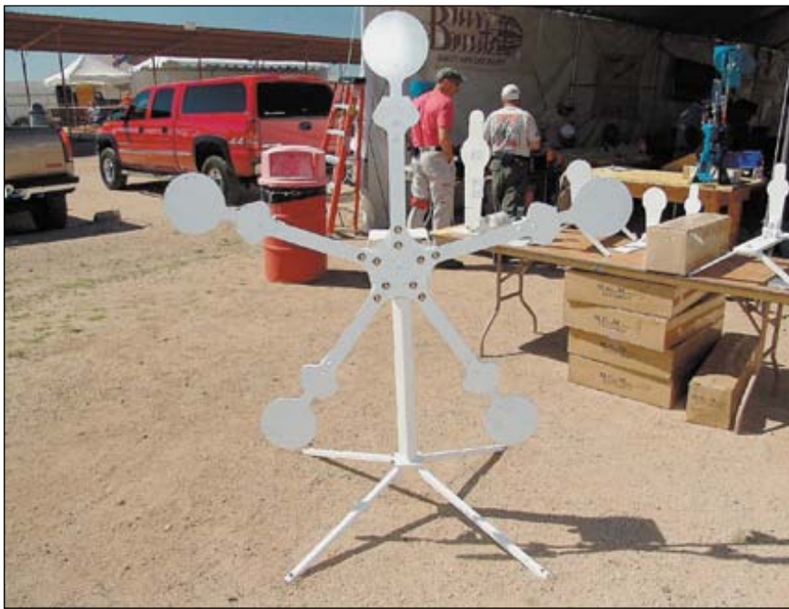
Подвижная мишенная установка – «Звезда» находится в покое. С каждой сбитой тарелкой она начинает раскачиваться всё быстрее и быстрее
