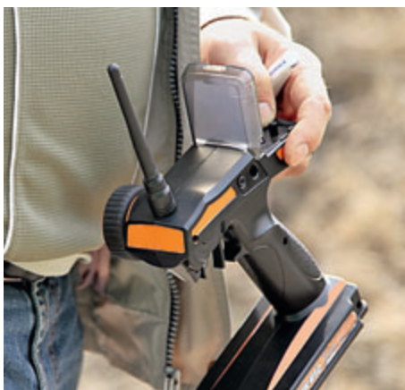
Для регистрации количества произведённых по мишени выстрелов применяется контрольная лента с электроприводом, размещаемая за мишенью. Команда на перемещение ленты подаётся дистанционно по радиоканалу с пульта
