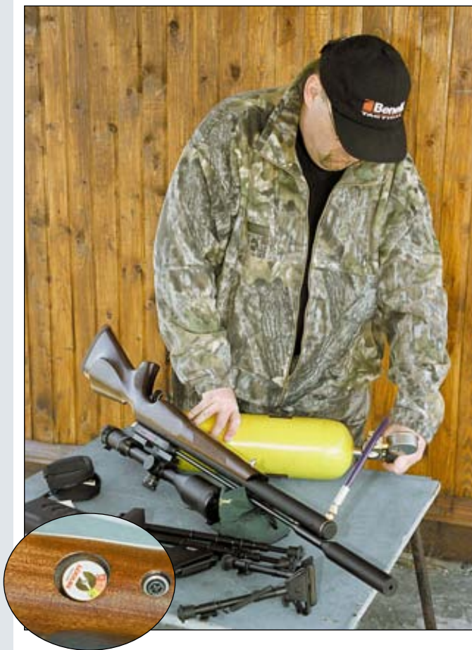
Наполнение резервуара винтовки сжатым воздухом
