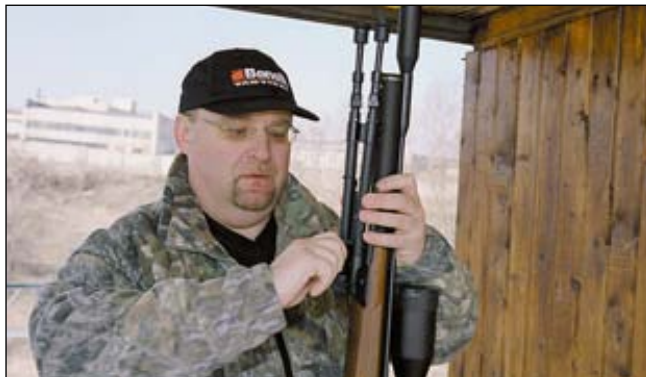
Стрельбу из различных положений облегчит складывающаяся сошка с регулируемой длиной стоек
