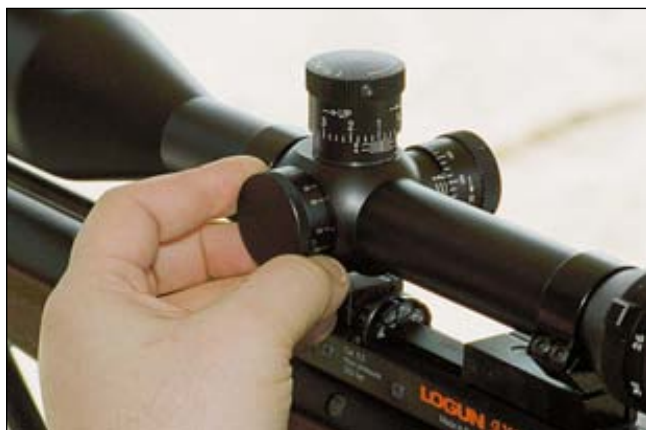
У данного прицела фокусировка объектива (устранение паралакса) производится вращением бокового барабанчика
